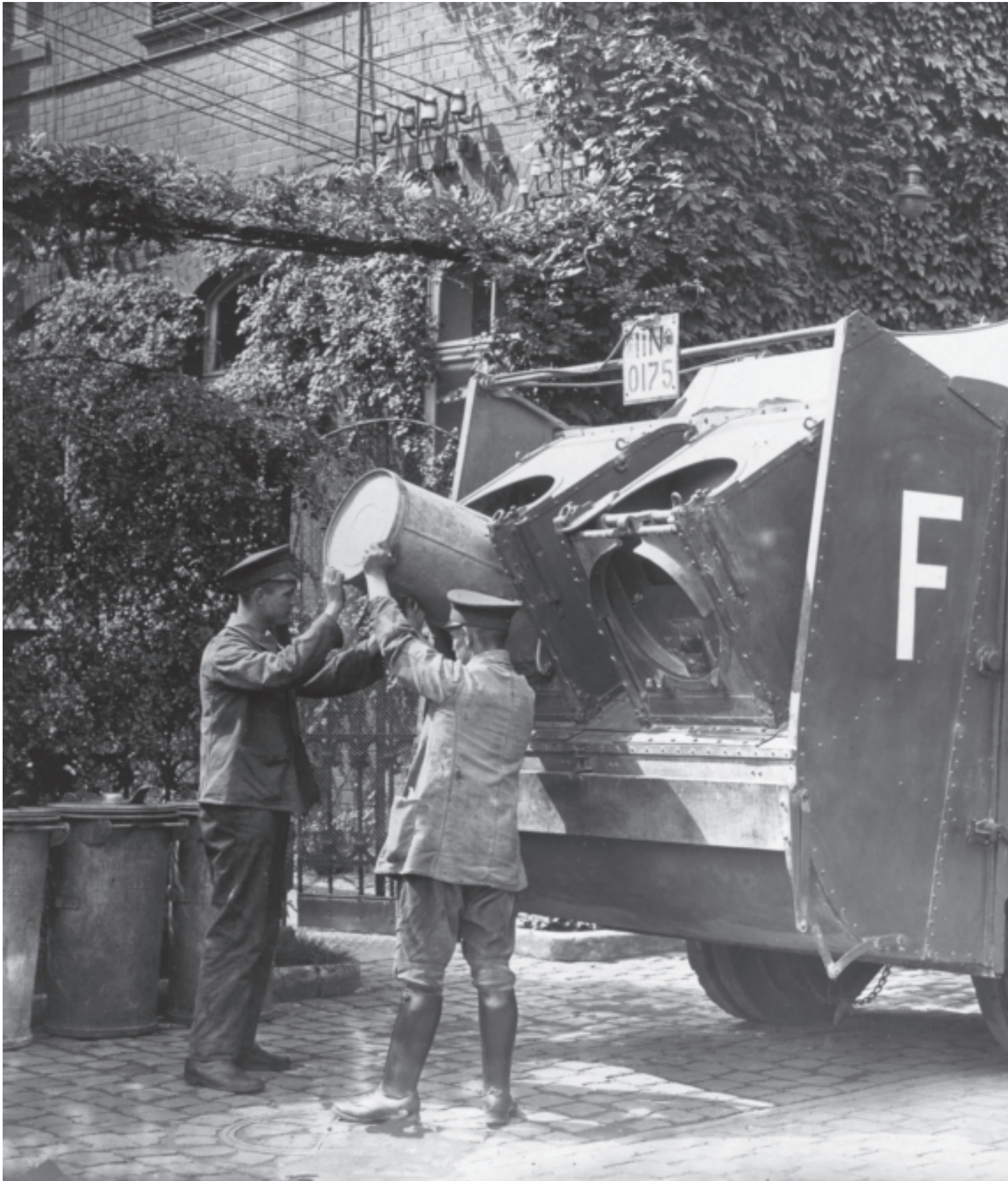
FAUN-Rolltrommelmüllwagen mit benzin-elektrischem Antrieb, Vorführung Düsseldorf 1928 Das Fahrzeug war mit zwei Schüttungen von Schmidt & Melmer für 110-l-Ringtonnen ausgestattet. Sichtbar am Fahrerhaus die Außensteuerung und Bremse.
